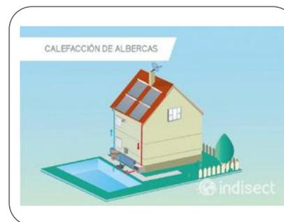
Consiste en la implementación de colectores ó tapetes solares cuya función será captar la radiación solar calentando el agua que se recirculará en el sistema.
