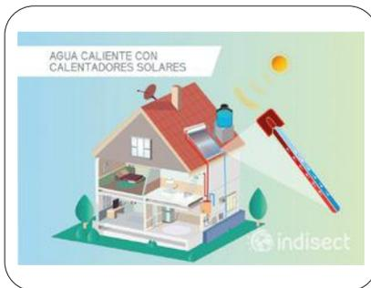
Los calentadores solares aprovechan la radiación solar para aumentar la temperatura del agua por medio de tubos de vidrio al vacío.
