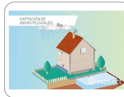
El aprovechamiento del agua de lluvia para diferentes usos, consiste en un sistema mediante el cual se recolectan las aguas pluviales en un tanque.
