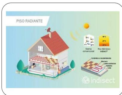
Consiste en la implementación de radiadores de calor generalmente de polietileno reticulado colocado en el piso.
